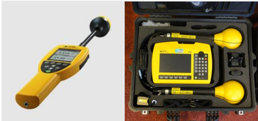
Figure 5 : matériel de mesure des champs électriques large bande à gauche et sélectif en fréquence à droite
