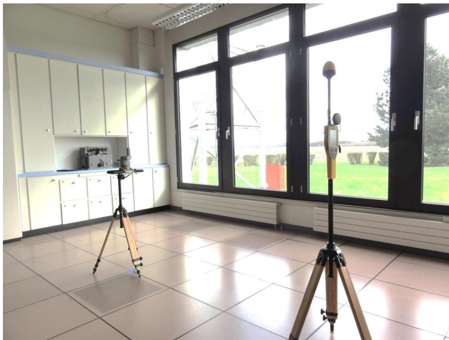
Figure 10 : configuration de la mesure COFRAC sur le compteur Honeywell TPR11
