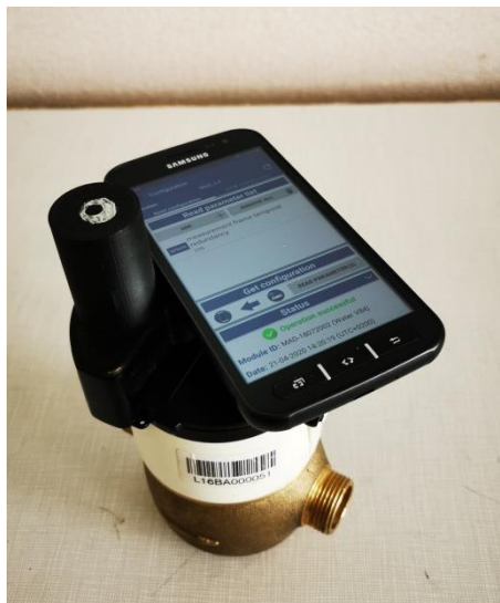
Figure 4 : smartphone équipé de l'application Kerlink Wirgrid NFC permettant de paramétrer les modules
