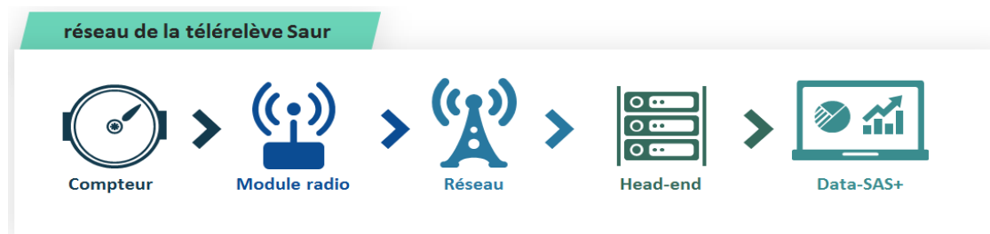
Figure 1 : principe de la chaîne communicante de la solution technique de télérelève retenue par Saur – source Saur
